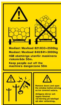
**WARNAUFKLEBER – KABINE.** Befinden sich innerhalb der Kabine, Modell 840 PRO. Dieser Aufkleber warnt wie nachfolgend erläutert vor mehreren Gefahren. Warnung vor dem Kontakt mit Hochspannungsstromleitungen. Seien Sie bei Arbeiten in unmittelbarer Nähe von Hochspannungsstromleitungen besonders vorsichtig, damit der
