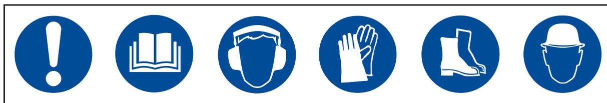
Der oben abgebildete Aufkleber kennzeichnet obligatorische Maßnahmen für den Einsatz von Schutzausrüstung und weist darauf hin, stets die Bedienungsanleitung zu lesen, bevor die Maschine in Betrieb genommen wird.
