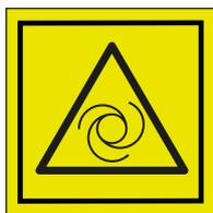
**WARNHINWEIS FÜR DEN FERNSTART VON MASCHINENTEILEN.** Gilt für Maschinen, die mit einer Winde ausgestattet sind. Ein Fernstart ist mit einer Funkfernsteuerung möglich, auch wenn sich kein Bediener in der Nähe der Maschine aufhält. Überzeugen Sie sich davon, dass sich niemand im Bereich um Kran und Winde aufhält und dieser frei von Hindernissen ist, bevor Sie diese Funktion starten.
