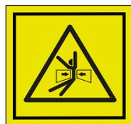
**QUETSCHGEFAHR - MITTELGELENK.** Es besteht die Gefahr schwerer Verletzungen, wenn sich der Körper oder Körperteile in den Teilen des Mittelgelenks der Maschine verfangen.
