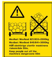
**WARNUNG FÜR MAX. BELASTUNG UND RISIKOBEREICH.** Die Höchstlast der Maschine beträgt 3.000 kg. Überschreiten Sie niemals diese Lastgrenze. Positionieren Sie die Last niemals auf dem Ladegatter, da die Gefahr besteht, dass die Last vom
